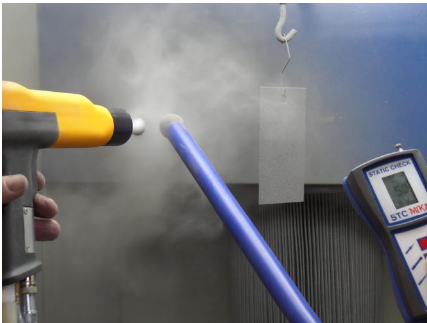
Urządzenie do pomiaru parametrów elektrycznych malowania proszkowego STC MIKA
