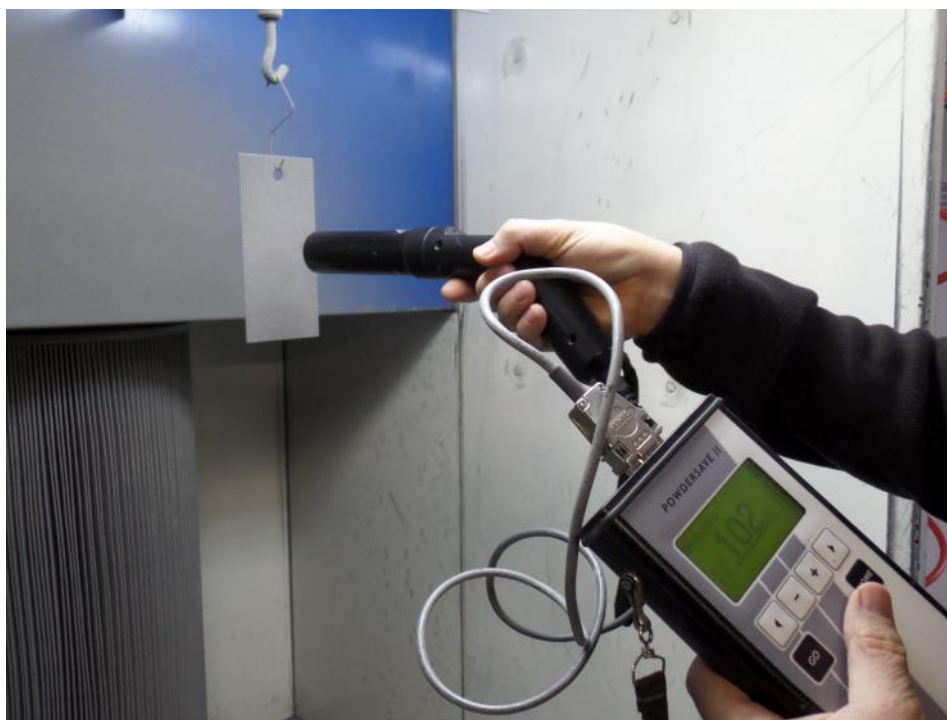
Pomiar grubości powłoki proszkowej przed utwardzeniem – POWERSAVE II
